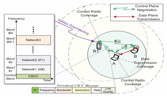
Fig. 3 The CSCC spectrum etiquette protocol.
