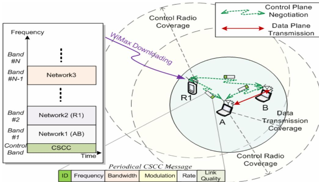
**Fig. 3 The CSCC spectrum etiquette protocol.**
