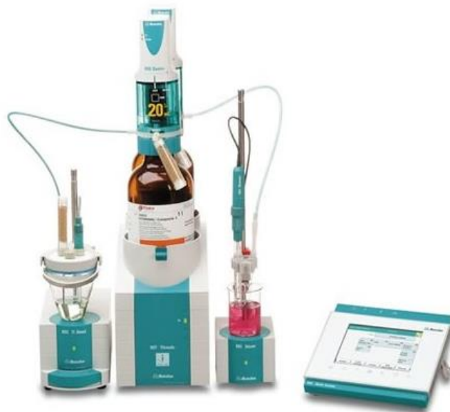
Figure 25. Metrohm Titrando 907 used for boron titration.
