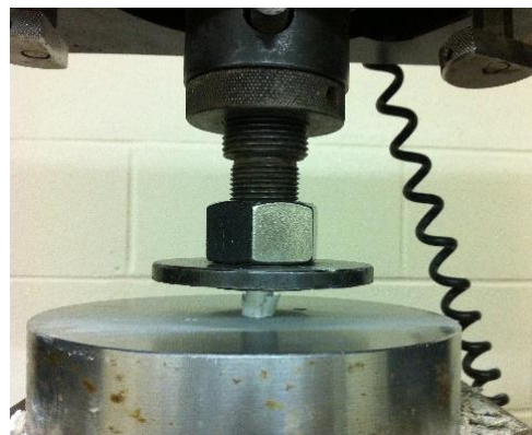
(d) Close up of the pellet compression test
